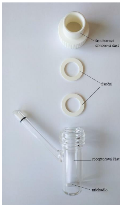
Obrázek 1: Vertikální difúzní cely se šroubením
